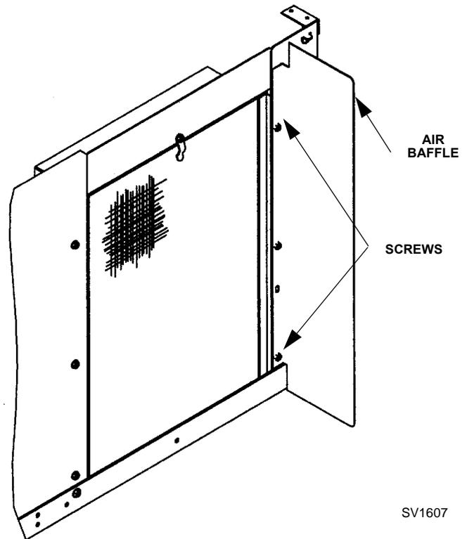
**Figure 2-2. Air Baffle**
