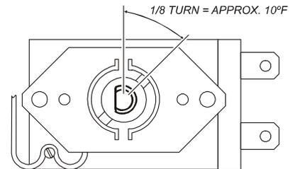
Fig. 10 Adjust Thermostat
