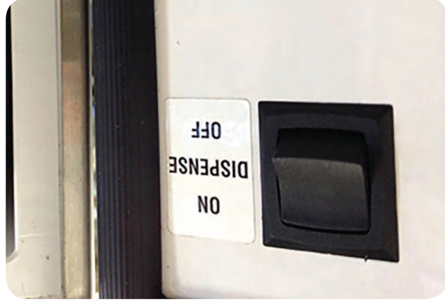
FIG 12 Boutons de distribution de produit - JDF-4S
