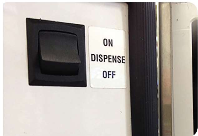
FIG 13 Interruptor de bloqueo de distribución
