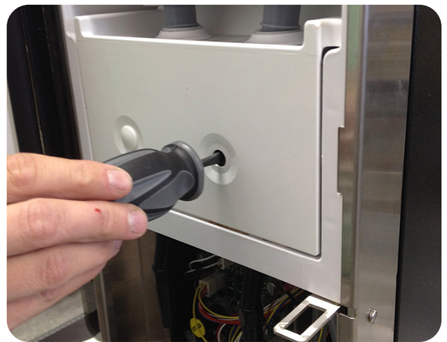
Ajustar el Flujo de Agua Usando Un Destornillador Plano
