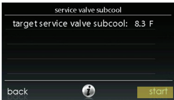
Figure 17 – Valeur cible de sous-refroidissement de valve de service A14574
