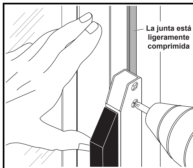
Figura 38. Ajuste lateral apropiado de la manija de la puerta
