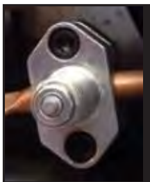
Vanne de piquage de conduite de réfrigération
