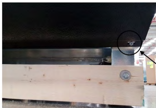
Tornillo del panel delantero
