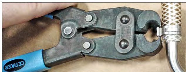
Figura 6-5 - Extracción de la abrazadera de manguera (herramienta Oetiker)
