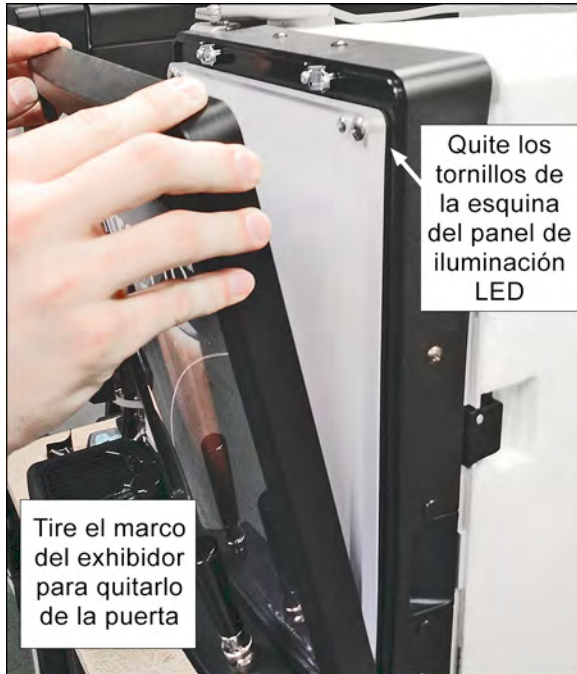
Figura 6-10 - Extracción de retroiluminación LED del exhibidor
