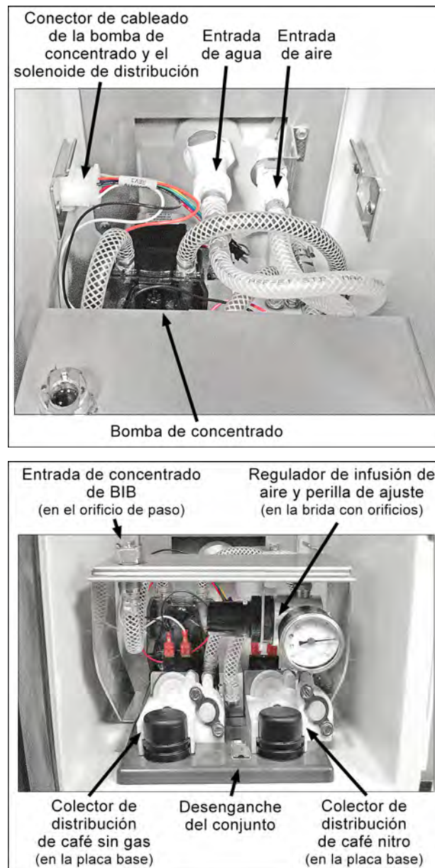
Figura 6-2 - Conjunto de mezcla y distribución en el gabinete
