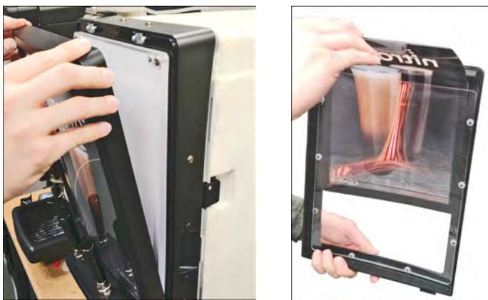
Figura 2-1 - Extracción del exhibidor con retroiluminación LED delantero
