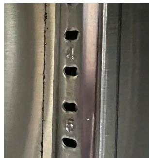
2. Ajustez les attaches à la hauteur requise en utilisant les fentes numérotées sur les taquets à rayon. Ajustez toutes les attaches avec leurs numéros correspondants sur les taquets à rayon.
