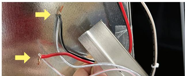
3. Raccordez les fils avec ceux de la nouvelle lampe. Le rouge au rouge et le noir au noir. Fixez à nouveau le connecteur électrique aux nouveaux fils.
