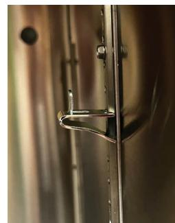
4. Répétez la procédure jusqu'à ce que toutes les autres attaches soient bien logées dans leurs fentes. Placez vos rayons sur les attaches.
