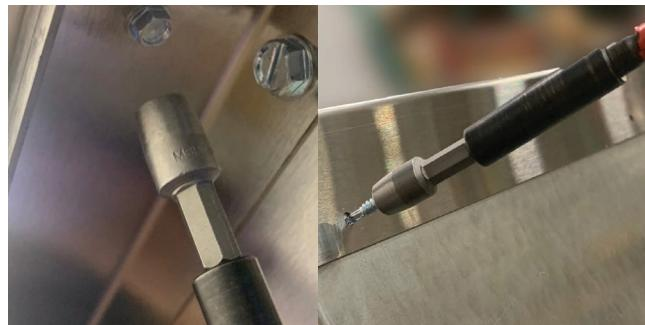
6. Fixez solidement le nouveau plateau en vissant les vis hexagonales à l'arrière et à l'avant de l'appareil.
