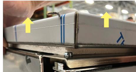
**1.** Trouvez l'emplacement des vis hexagonales sous la face inférieure du plateau en inox et dévissez-les à l'aide d'un tournevis hexagonal de 0,6 cm. (Ignorez les étapes 1 à 3 si votre appareil est doté d'un plateau brut)
