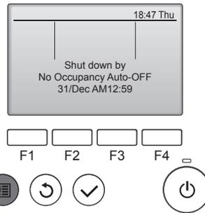
④ Le message à gauche s'affiche si le fonctionnement a été arrêté automatiquement par le réglage No occupancy Auto-OFF (Arrêt automatique si la pièce n'est pas occupée).
