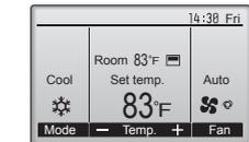
Appuyez sur la touche [F1] pour balayer les modes de fonctionnement parmi : "Cool" (Froid), "Dry" (Déshu.), "Fan" (Ventil.), "Auto", et "Heat" (Chaud). Sélectionnez le mode de fonctionnement désiré.
