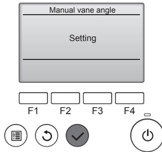
Sélectionnez la sortie d'air désirée, de 1 à 4, à l'aide de [F1] et [F2].
