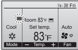
Le filtre apparaît sur l'écran principal dans le mode complet quand les filtres doivent être nettoyés.
