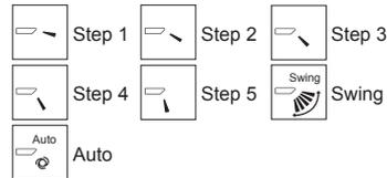
Seleccione "Swing" (Oscilación) para que los álabes se muevan hacia arriba y hacia abajo automáticamente. Cuando configure de "Step 1" (Posición 1) a "Step 5" (Posición 5), el álabes estará fijo en el ángulo seleccionado.
