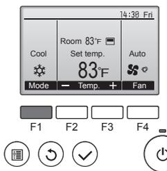
Presione el botón [F1] para ver los modos de operación en el orden de: "Cool" (Frío), "Dry" (Secar), "Fan" (Vent.), "Auto" y "Heat" (Calor). Seleccione el modo de funcionamiento deseado.
