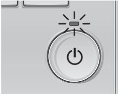
Pressez la touche [MARCHE / ARRÊT]. La lampe Marche / Arrêt s'allume en vert, et l'appareil démarre.
