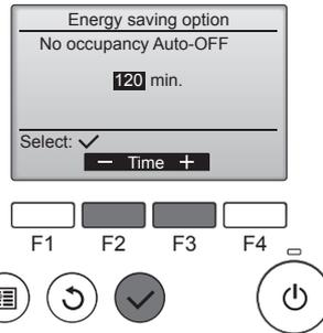
③ Quand No occupancy Auto-OFF (Arrêt automatique si la pièce n'est pas occupée) est sélectionné. Réglez la durée à l'aide de la touche [F3] ou [F4].
