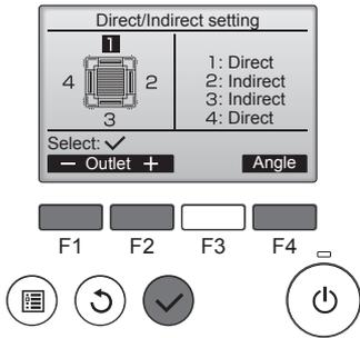
③ Quand Direct/Indirect est sélectionné, réglez chaque sortie d'air. Sélectionnez la sortie d'air à l'aide de la touche [F1] ou [F2], et changez le réglage à l'aide de la touche [F4]. Après avoir modifié les réglages pour toutes les sorties d'air, appuyez sur la touche [CHOIX] pour enregistrer les réglages.
