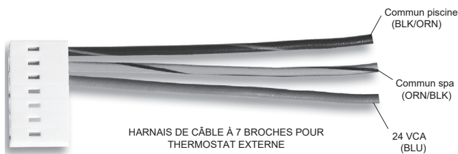
Figure 34. Harnais de câbles
