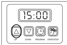
To verify the actual generator temperature, press and hold the **UP ARROW** button. The unit will display the actual generator temperature.
