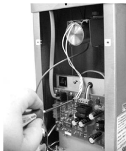
Figure 9 : Débrancher les fils du solénoïde de la carte de circuits imprimés
