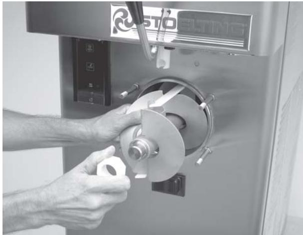
**Figure 15. Auger Shaft Removal**
