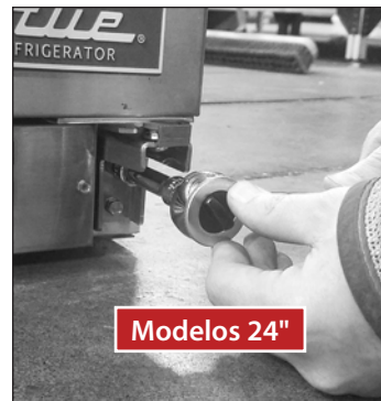
Fig. 1. Los modelos de 24 y 27 utilizan bisagras inferiores diferentes.
