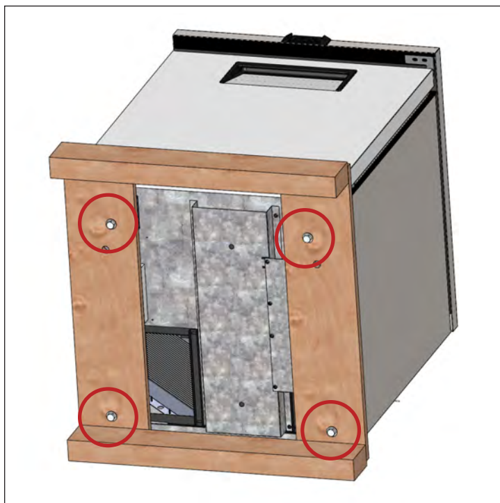
Fig. 3. Retire todos los pernos de transporte.
