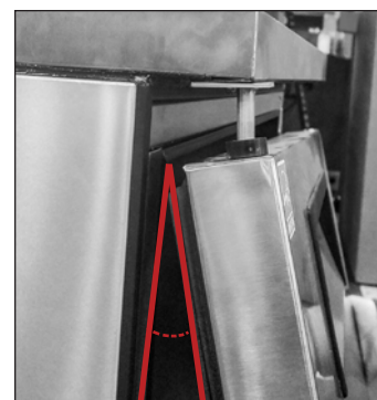
Fig. 10. De ser necesario, solo use ángulos poco profundos al posicionar la puerta.
