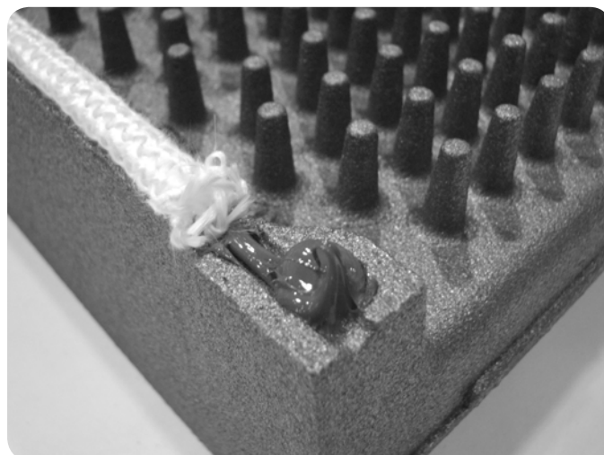
Illustration 4b Mise en place de nouveau silicone dans les douilles.
