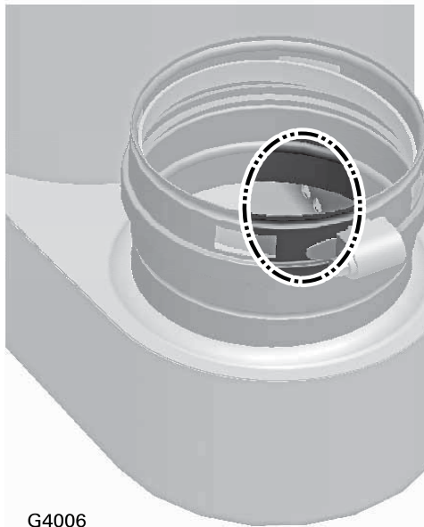
Figure 83 Trous de drainage du conduit de fumée du récupérateur
