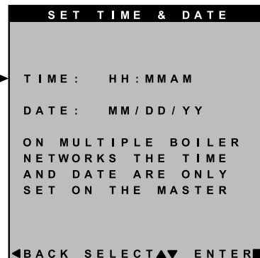
Figure 4 Afficheur du module de commande de la chaudière SlimFit Menu de l'UTILISATEUR — (régler la date et l'heure, réinitialiser les anomalies).
