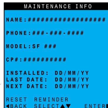
Figure 5 Afficheur du module de commande de la chaudière SlimFit écrans d'avis de maintenance .
