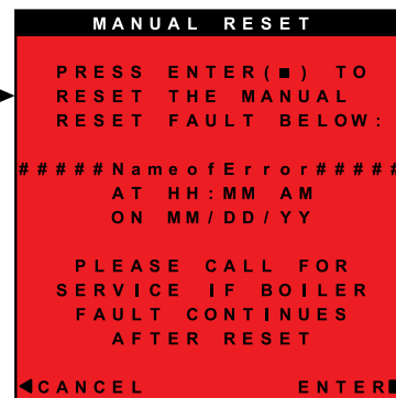
Figure 6 Afficheur du module de commande de la chaudière SlimFit ÉCRAN DE VERROUILLAGE — l'écran vire au rouge lorsque la chaudière est verrouillée — surligner et sélectionner MANUAL RESET pour réinitialiser la chaudière comme illustré ci-dessous.
