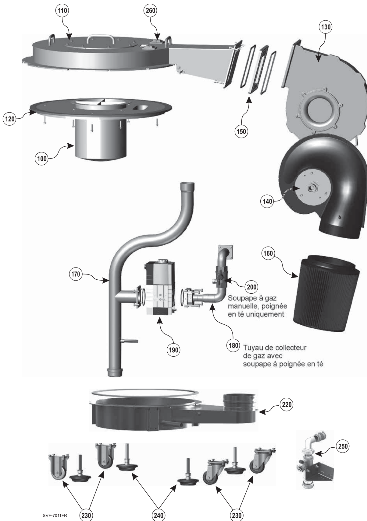
Figure 109 Brûleur, souffleur, plaque de recouvrement, venturi, train de gaz et divers
