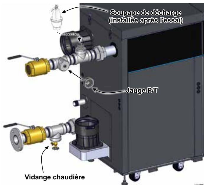
Figure 7 Raccordements des tuyaux pour l'essai hydrostatique
