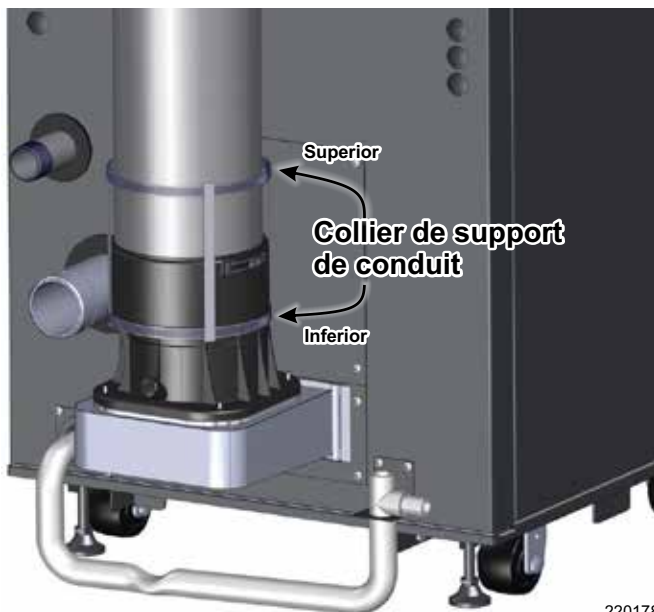
Figure 20 Collier de support de conduit, installé
